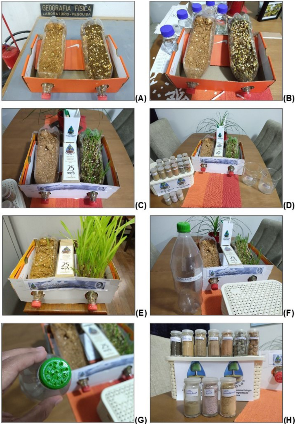
FIGURA 2: Passos para elaboração do material didático com os solos utilizados na tese. Construção de parcelas de erosão e acompanhamento da taxa de crescimento vegetal (A, B, C, D e E); Confeccção de um simulador de chuva (F e G); e kits de solo com distintas propriedades físicas, químicas e mineralógicas (H). Foto: Leonardo S. Pereira (2019).
