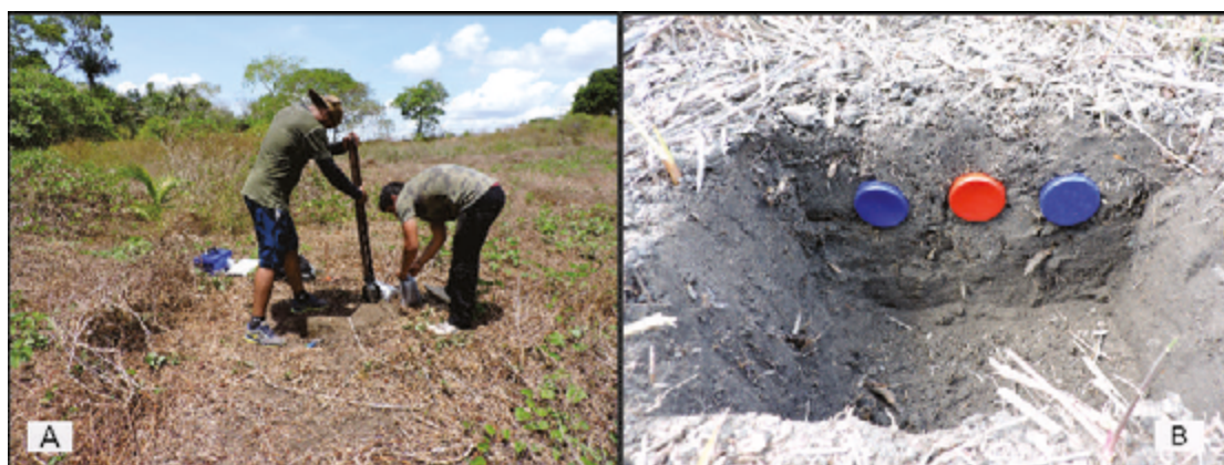
Figura 2 - (A) Abertura das mini-trincheiras na área do sítio Vila Triunfo e (B) Anéis volumétricos fixados nos primeiros 10 centímetros. Fonte: Trabalho de Campo (2019).
